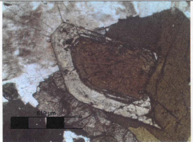
(j) Cristal de allanita com borda metamictizada, causando fraturas no plagioclásio. Amostra 691, polarizadores descruzados.
